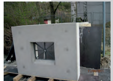
Probestück für die neue Stahlbetonbrüstung
