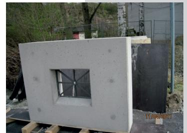
Probstück für die neue Stahlbetonbrüstung
